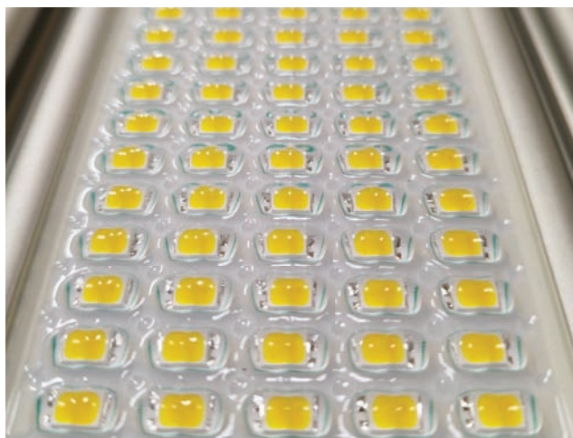
Вид на блок линз светового модуля светильника «ОХРА»
