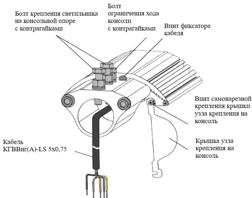
Рисунок 3 – Установка светильника
