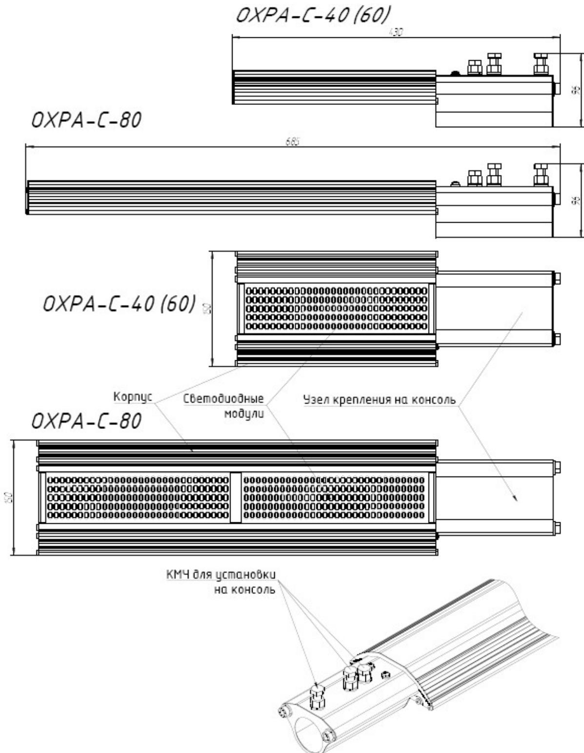
Рисунок 2 – Внешний вид светильника
