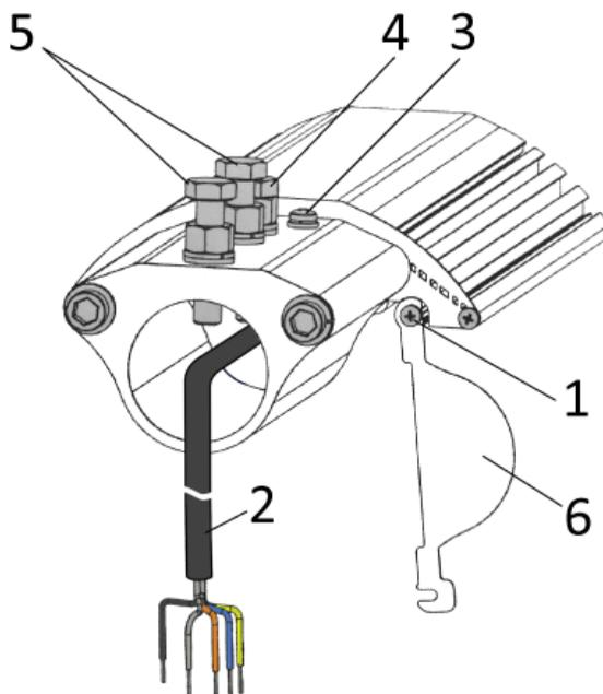
1 – винт самонарезающий, для крепления заглушки, 2 шт; 2 – кабель КГВВнг(А)-LS 5x0,75; 3 – винт фиксатора кабеля, 2 шт; 4 – болт с контргайками для ограничения хода консоли; 5 – болт с контргайками, для крепления светильника на консольной опоре, 2 шт; 6 – заглушка.
