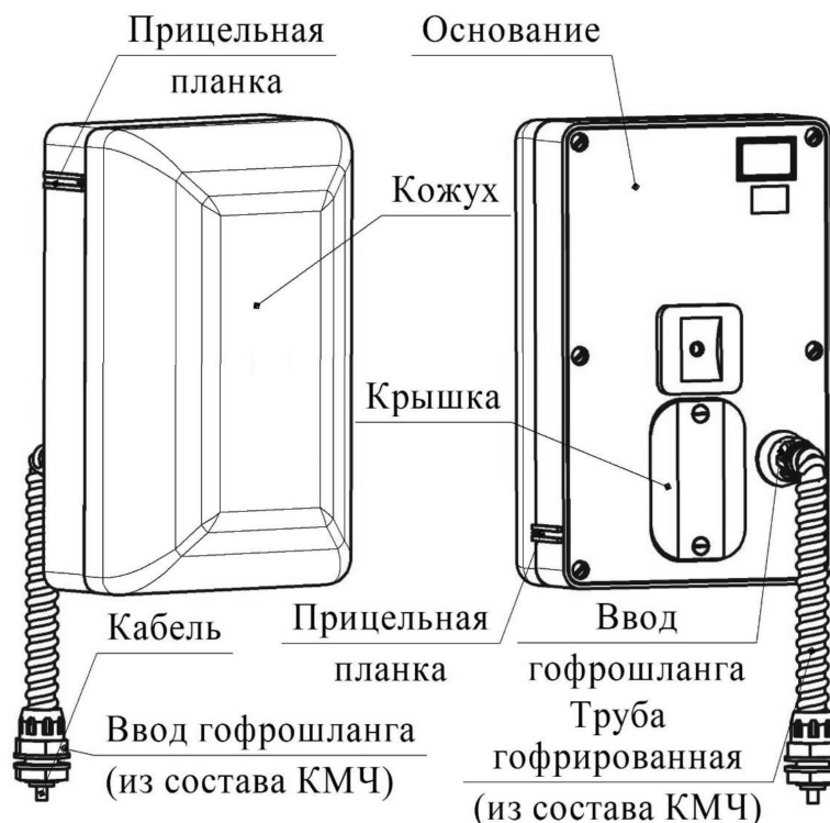
Рисунок 6 – Конструкция блоков ПРД и ПРМ извещателей М100 и М200
